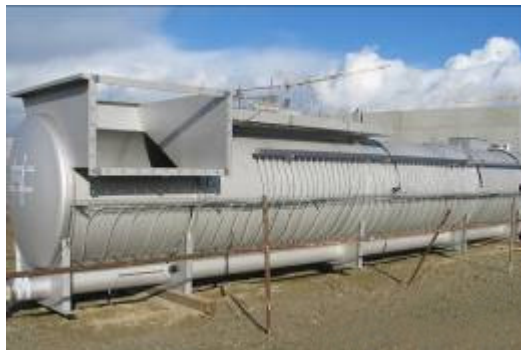
Postrojenje za mehaničku obradu – prije ugradnje
